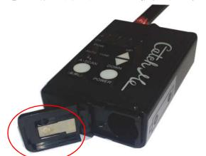
長年使用していると左写真のように金属端子が汚れていることがあります。汚れているようでしたら研磨剤を使うときれいになります。
